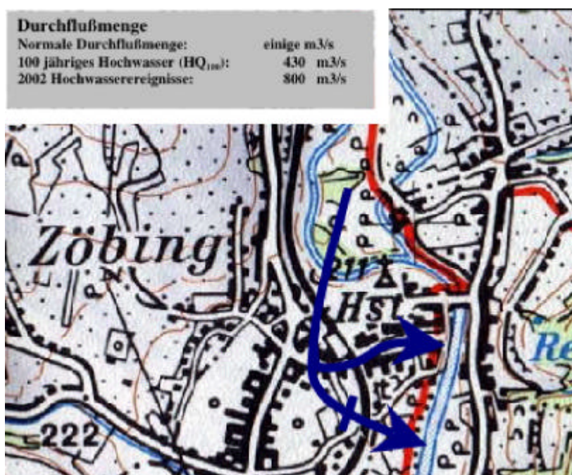
Abb. 7-4: S-förmiger Flußlauf des Kamps und Wasseraustritt aus dem Flußbett und Strömungsverlauf während des Hochwassers in Zöbing
