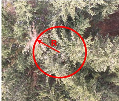
**Abb. E- 7:** Zentriergenauigkeit der Drohne über dem geschädigten Baum.
