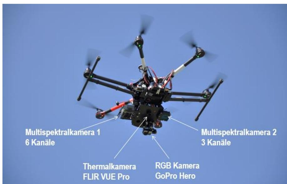
**Abb. E- 10:** Eingesetzter Hexakopter mit den einzelnen Kamerasystemen.
