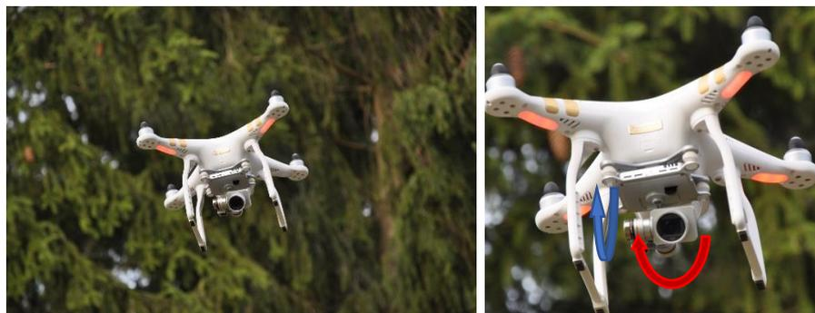
**Abb. E- 4:** Handelsübliche UAV DJI Phantom 3 mit vormontierter RGB-Kamera im Flug und Detailaufnahme zur Visualisierung der Kamerapositionierungsmöglichkeiten.
