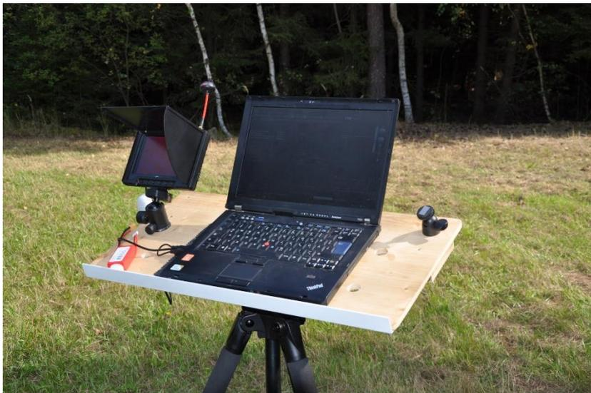
**Abb. E- 14:** Kontrollstation für die Befliegung, am linken Bildschirm erfolgt die Live-Übertragung, der Laptop dient zur Flugplanung und -überprüfung.
