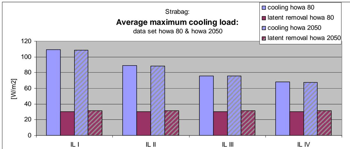
**Graph 28: Strabag: maximum cooling loads for “howa 80” and “howa 2050” under different levels of internal load** Fehler! Verweisquelle konnte nicht gefunden werden.
