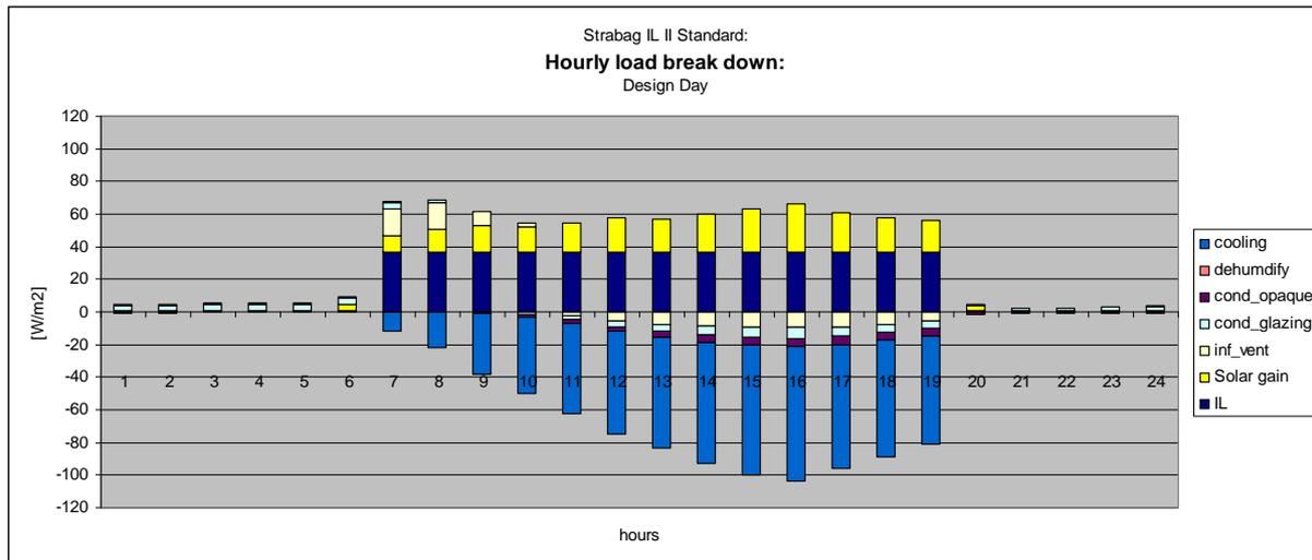
**Graph 23: Hourly cooling load break down in Strabag** Fehler! Verweisquelle konnte nicht gefunden werden.
