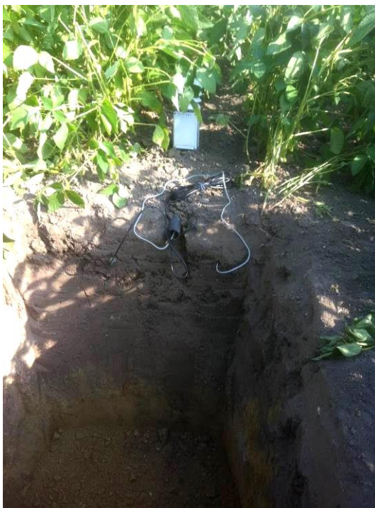
Abb. G- 6: Profilgrube am Standort 4 Rittler Kotzian (Bruck/Leitha) mit den eingesetzten Datalogger-Messfühlern für Temperatur und Feuchte.
