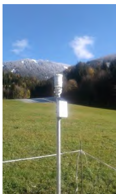
Abb. H-3: Wetterstation (Atmos41) (Meter Group AG) ca. 200 m. südlich des Versuchsfeldes.
