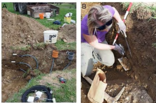
Abb. H-7: Einbau der Bodenfeuchtesensoren in unterschiedliche Tiefen (A) und Entnahme einer Bodenprobe zum Zeitpunkt der Versuchsanlage (B).
