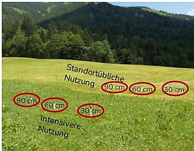
Abb. H-6: Fertig eingebaute Sickerwassersammler an der standortüblichen und der intensiven Fläche in den unterschiedlichen Tiefenstufen von 30 cm, 60 cm und 90 cm (roter Kreis).
