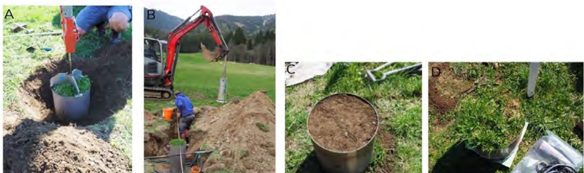
Abb. H-5: Einbau der 6 Sickerwassersammler in drei unterschiedlichen Tiefen (30 cm, 60 cm und 90 cm) an der Versuchsfläche (A und B) sowie die gestochenen Bodenmonolithe zum Zeitpunkt des Einbaus (C und D).
